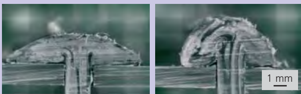
Querschnittsaufnahmen zweier umgeformter Faserverbundkunststoffstege
